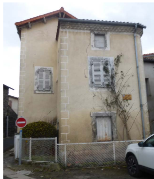
En haut : enduit à pierres vues. Les joints ne sont pas creux et viennent «mourir» sur la surface assisée des pierres. En bas : deux décors peints, qui valorisent les mêmes éléments : chaines d'angles, encadrements de fenêtres, filets soulignant les génoises.
